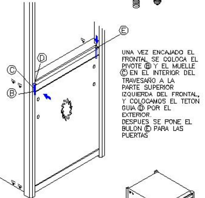
UNA VEZ ENCAJADO EL FRONTAL SE COLOCA EL PIVOTE (E) Y EL MUELLE (B) EN EL INTERIOR DEL TRAVESAÑO A LA PARTE SUPERIOR IZQUIERDA DEL FRONTAL, Y COLOCAMOS EL TETON GUIA (D) POR EL EXTERIOR. DESPUES SE PONE EL BULON (E) PARA LAS PUERTAS
